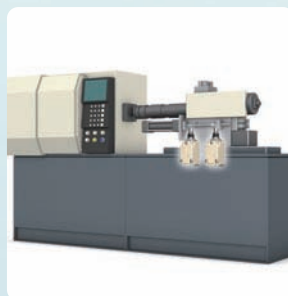
检测成型机液压油缸的 前进后退
