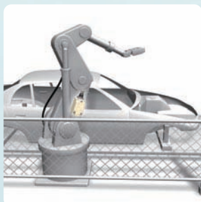
检测焊接机械臂的运动
