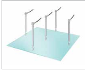
测量玻璃的挠曲 选用测量力轻的型号，可以高精度测量工件而不划伤。
